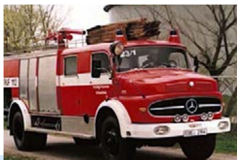
Tankschlöschfahrzeug TFL 32/50 Daimler-Benz LA 1920 mit Heckpumpe
