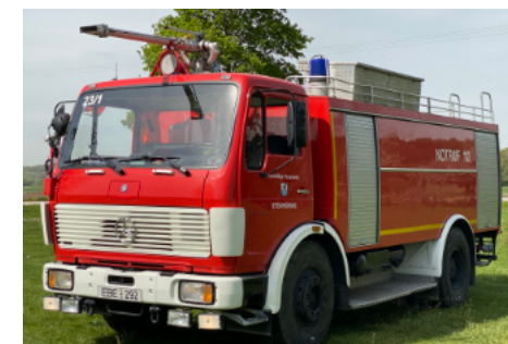
Tanklöschfahrzeug TLF32/80, Daimler-Benz mit Heckpumpe und Dachwerfer
