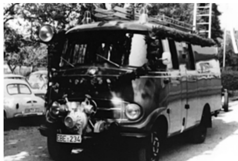
Löschgruppenfahrzeug LF8 Daimler-Benz LF319 - B mit Vorbaupumpe
