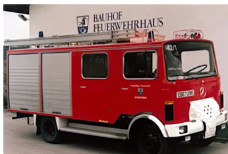
Löschgruppenfahrzeug LF8, Daimler-Benz LP709 mit Vorbaupumpe
